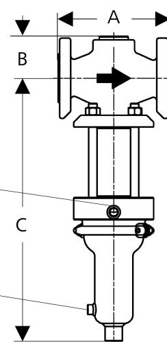
Steuerleitungsanschluss G 1/4
