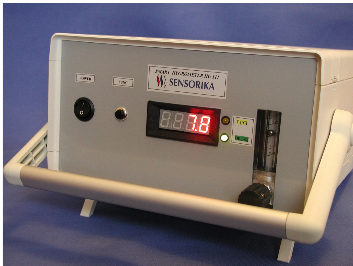
Pohled na čelní stranu hygrometru HG 111/121-xxxxxF s plováчковým průtokoměrem 0 ÷ 4 litrů/min pro měření tlakového rosného bodu plynu s max.přetlakem 16 barů
