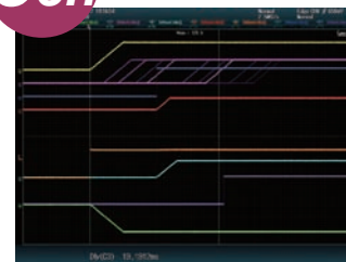
例：多输出电源或转换器的启动序列测试 一次侧和二次侧电压/电流以及电源控制信号
