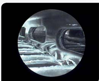
冲压工序后大型通气板的毛刺形成
