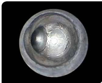
在加工过程中检查喷嘴体内部毛刺的位置并清除毛刺
