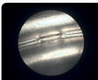
由于金属板材位置不当导致的焊缝不连续
