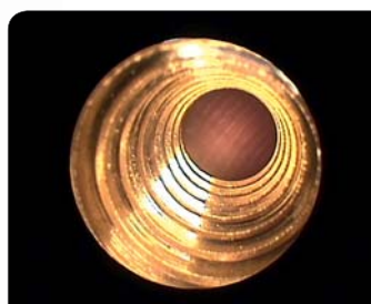
空心轴内部用于精确锁定的精细切割螺纹
