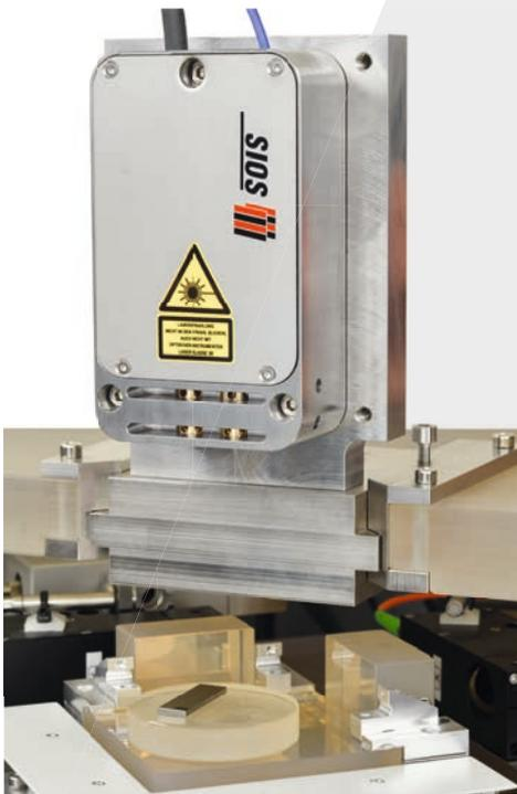
Der Messbereich für die Längenmessung liegt bei mehreren Metern, wenn kippinvariante Reflektoren für die Messungen verwendet werden. Das System ist modular aufgebaut und kann dadurch an die Messaufgabe angepasst werden.
