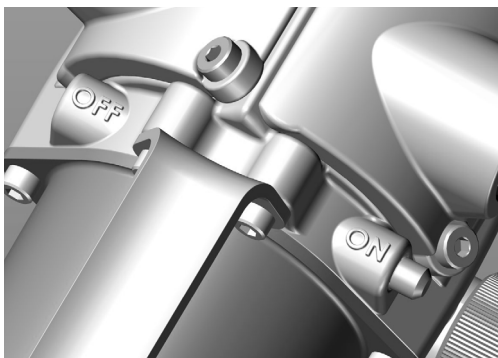
Pompe hors tension
