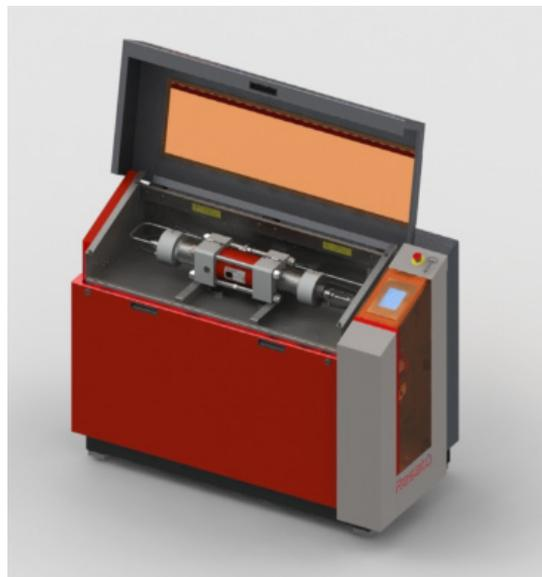
**La pompe Resato PJ4-4000 fonctionne sur le principe de surpression et est entraîné par une pompe électro-hydraulique, avec seulement 25 litres d'huile. La pression de l'amplificateur est réglable via l'IHM ou via la pompe avec une pression de travail de 300 à 3800 bar. La pompe et l'écran tactile PLC suivent les instructions du programme et ne consomment de l'énergie et de l'eau qu'en cas de besoin.**
