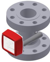
Durch den einzigartigen Aufbau der Messarmatur mit zylindrischem Messrohr und konischem Schwebekörper können die Geräte problemlos mit dickwandigem Messrohr hergestellt werden. Dies ermöglicht den Einsatz in Hochdruck-Anwendungen, für die es sonst kaum einsetzbare Messgeräte gibt.
