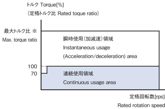
※ 最大トルク比はモータタイプにより異なります。(最大トルク/定格トルク)
