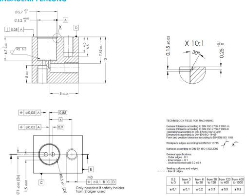
Die maximale Montagekraft, mit der das Ventil in die Aufnahme gedrückt werden darf, beträgt 30 N. Es wird empfohlen, das Ventil bzw. die O-Ringe bei der Montage zu schmieren (z. B. mit Alkohol oder DI-Wasser, je nach Kompatibilitätsbeschränkungen).
