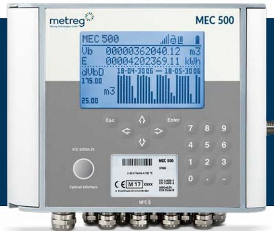
MEC500 ist ein Mengenumwerter, der eine PTZ-, PT- oder T-Umwertung ermöglicht. Das Gerät misst Volumen, Energie und Durchfluss von Gas. Hauptsächlich batteriebetrieben kann es auch an eine externe Stromquelle angeschlossen werden. Das Gerät wandelt die vom (Turbinenrad-, Drehkolben-, Ultraschall-) Gaszähler ermittelte Volumenmenge in den Normzustand um.
