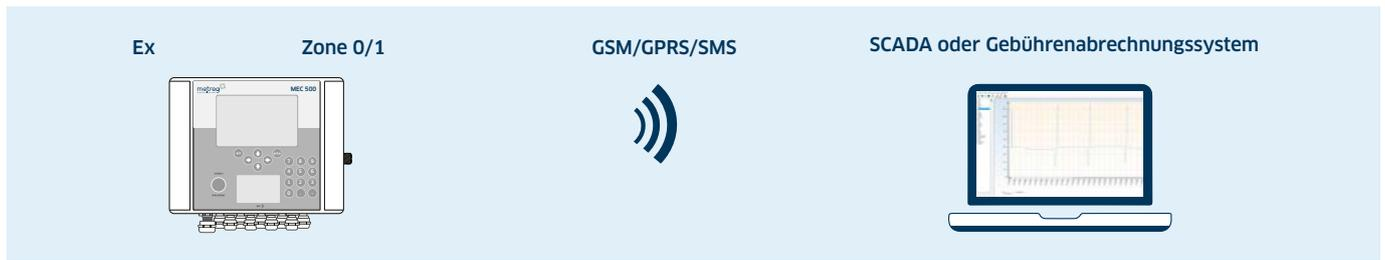
2. Fernauslesen – Verbindung über Kommunikationsschnittstellen INT-S3, RTU-Controller unabhängig
