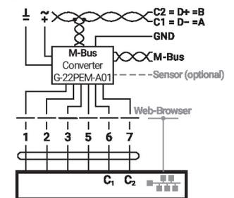
M-Bus parallel Modbus TCP oder BACnet IP
