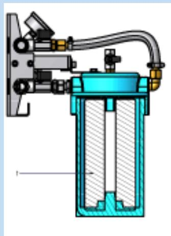
Filterpatrone für 2 fach + 4 fach Filtereinheit
