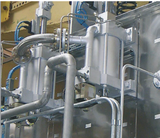
安装在 40 MW 蒸汽轮机上的福伊特涡轮股份有限公司生产的 WSR 位阀（图片来源：MAN Turbo）
