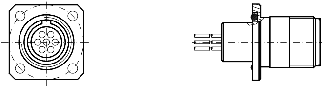
Druckwasserdichte Schutzkappe für Stecker Watertight protecting cap for plug
